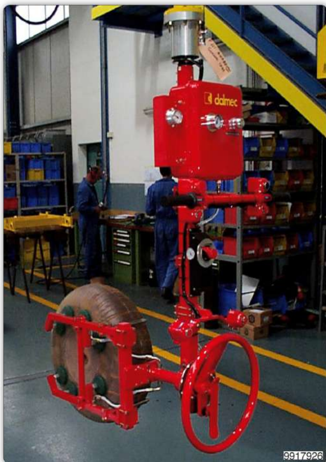
Манипулятор с приспособлением с присосами ("Venturi") для захвата, наклона и перемещения тороидальных баллонов.
