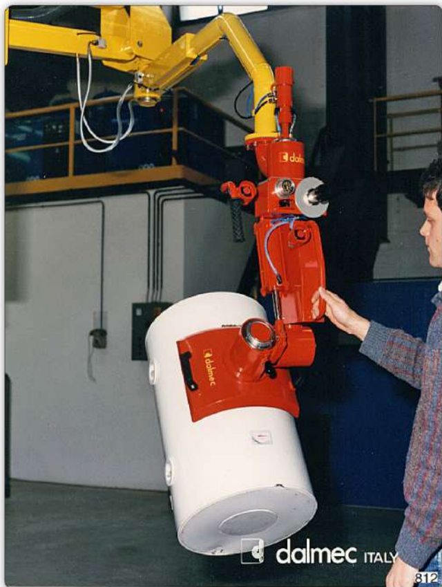
Манипулятор Partner типа PMC в исполнении на стойке с приспособлением с присосами "вентури" ("Venturi") для захвата, ручного поворота и перемещения бойлеров.
