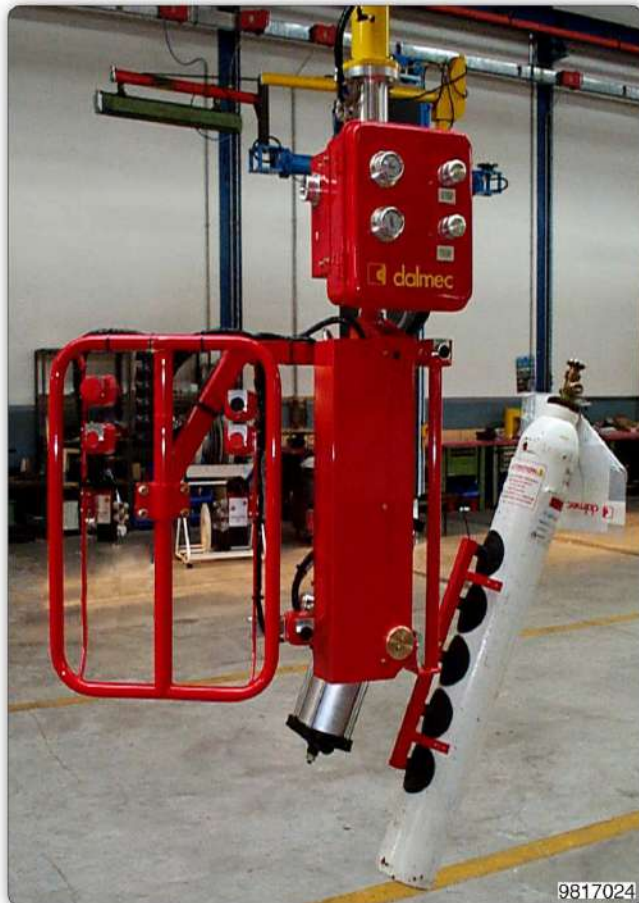
Манипулятор с приспособлением с присосами ("Venturi") для захвата, наклона и перемещения ресиверов.
