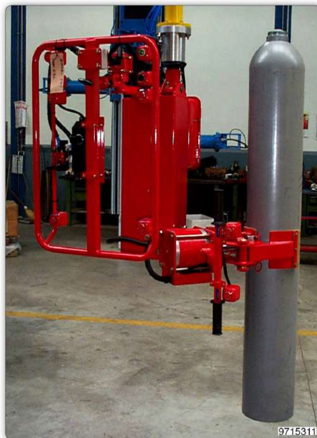
Манипулятор с пневматическим захватом, наклоном на 90° при помощи пневмопривода и ручным переворотом на 180° баллонов различных размеров.
