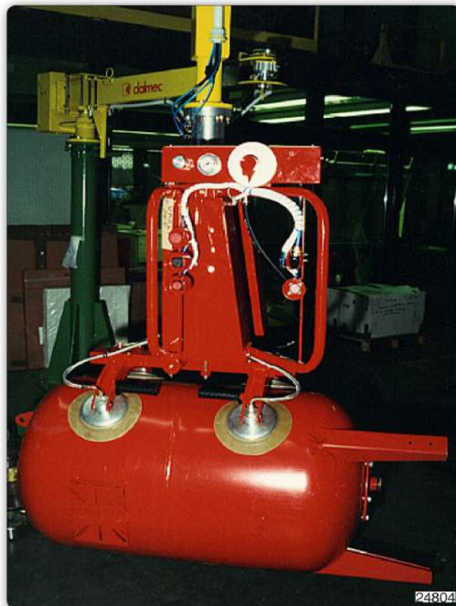
Манипулятор с приспособлением с присосами "Вентури" ("Venturi") для захвата, наклона и перемещения ресиверов.
