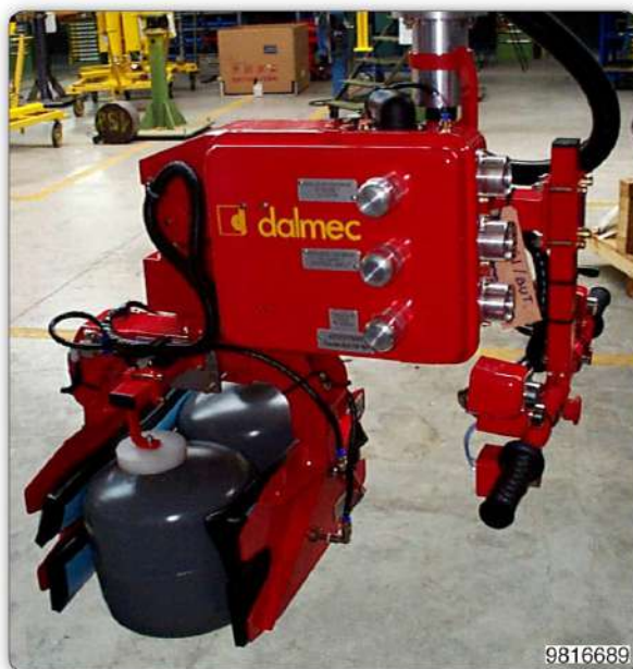
Манипулятор с приспособлением с надувными подушками для захвата одного или двух баллонов.
