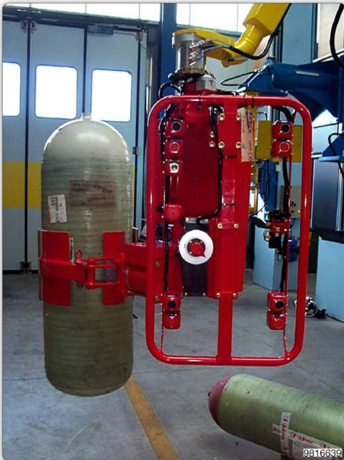
Манипулятор с пневматическим захватом, для наклона на 90° при помощи пневмопривода и перемещения баллонов различных размеров.
