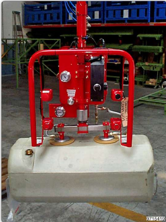
Манипулятор с приспособлением с регулируемыми присосами ("Venturi") для захвата и перемещения ресиверов.
