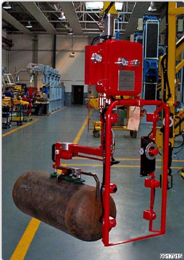
Манипулятор с приспособлением с присосами ("Venturi") для захвата, ручного поворота и перемещения ресиверов.
