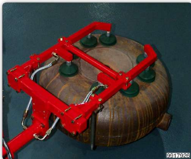
Манипулятор с приспособлением с присосами ("Venturi") для захвата, наклона и перемещения тороидальных баллонов.
