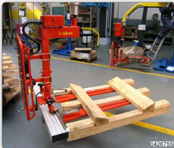
Приспособление с регулируемыми вилами, с поворотом груза при помощи пневмопривода и с телескопическими элементами управления.
