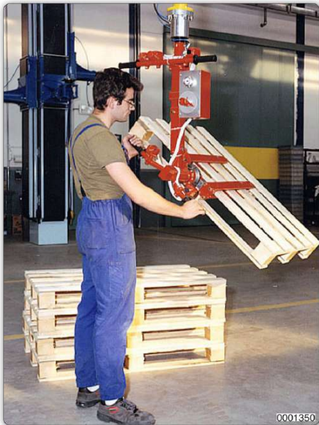
Манипулятор с вильчатым приспособлением и ручным переворотом на 180°, предназначенный для захвата и поворота поддонов.
