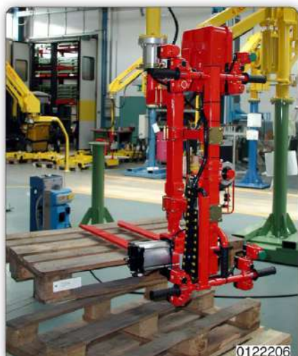
Приспособление с регулируемыми вилами, с поворотом груза при помощи пневмопривода и с телескопическими элементами управления.
