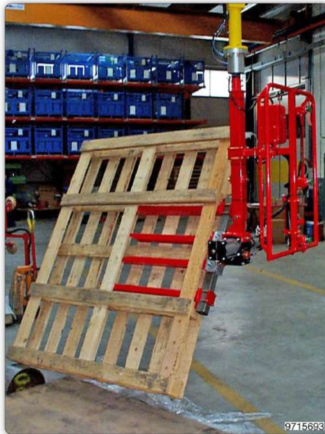
Вильчатое приспособление с пневматическим переворотом на 180° для захвата и поворота поддонов.
