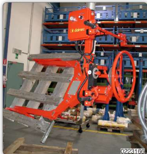
Манипулятор со специальными вилами для захвата и перемещения поддонов из нерж. стали.
