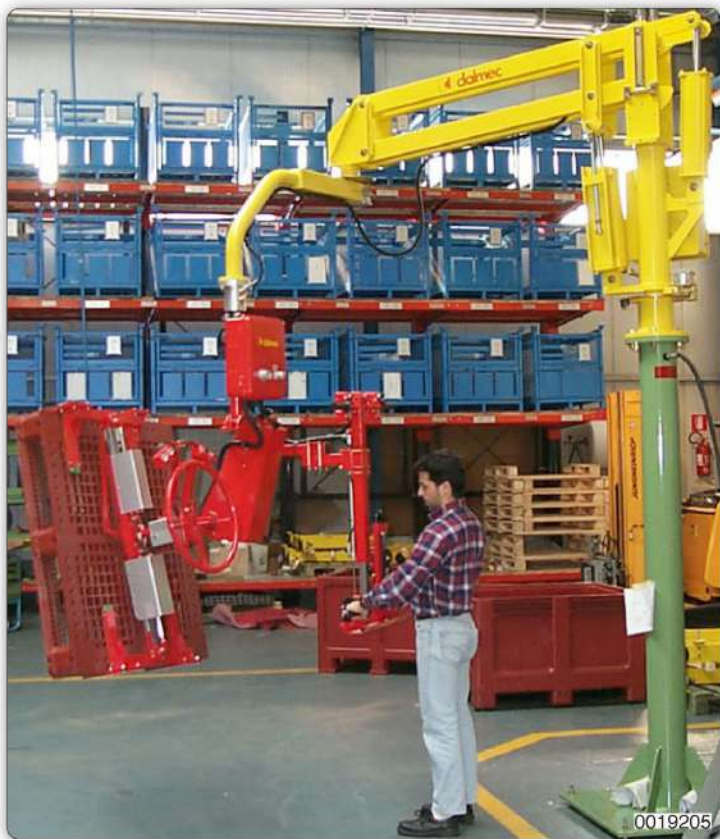
Манипулятор Partner типа PMS в исполнении на стойке с клещевым приспособлением для захвата, пневматического наклона и ручным вращением пластмассовых поддонов.
