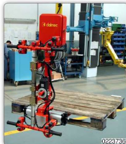
Вильчатое приспособление с поворотом груза при помощи пневмопривода.
