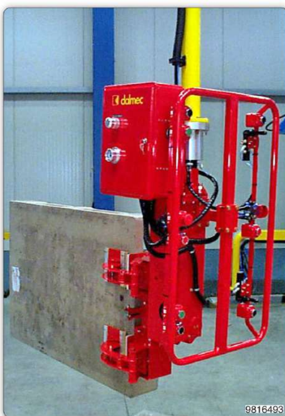
Клещевое приспособление для захвата с вращением поддонов при помощи пневмопривода.
