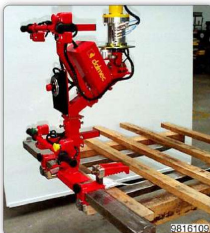
Приспособление с регулируемыми вилами и устройством блокировки.
