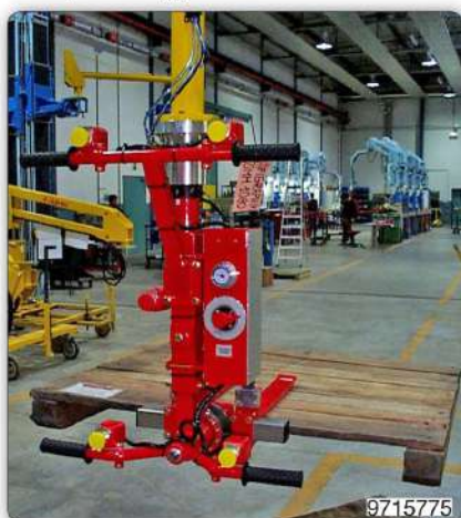
Вильчатое приспособление с ручным поворотом груза.
