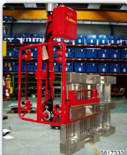
Манипулятор со специальными вилами для захвата и перемещения поддонов из нерж. стали.
