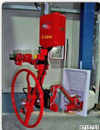
Манипулятор с приспособлением с присосами (Venturi) для захвата и ручного поворота моек.
