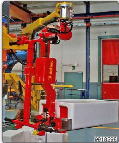
Манипулятор с приспособлением с регулируемыми вилами для перемещения моек.
