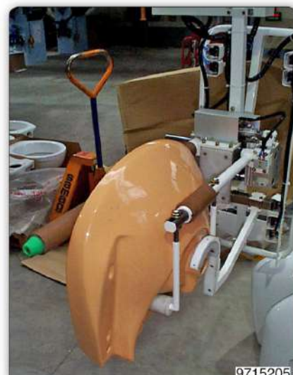
Манипулятор с регулируемым вильчатым приспособлением для захвата и перемещения раковин.
