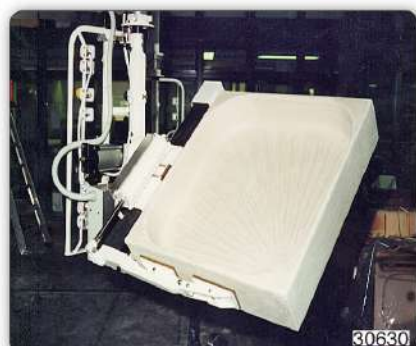
Манипулятор с пневматическим зажимом для захвата, поворота и перемещения душевых поддонов.
