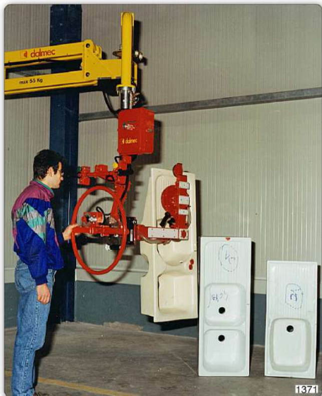
Манипулятор Partner в исполнении на стойке с приспособлением со взаимозаменяемыми присосами, предназначенный для захвата и перемещения раковин разных размеров.
