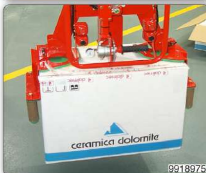
Манипулятор с зажимным приспособлением для захвата сантехнических изделий, их размещения в картонные коробки, захвата запечатанных коробок и их складирования на поддон.
