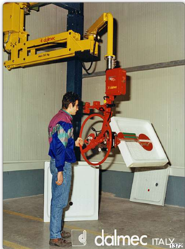
Манипулятор Partner типа PMF в подвесном исполнении с приспособлением с присосами ("Venturi") для захвата, поворота вручную и перемещения душевых поддонов.
