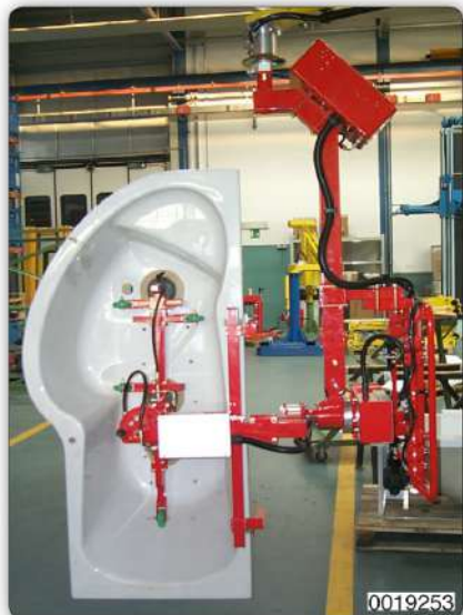
Манипулятор с приспособлением с присосами (Venturi) для захвата и поворота ванн.
