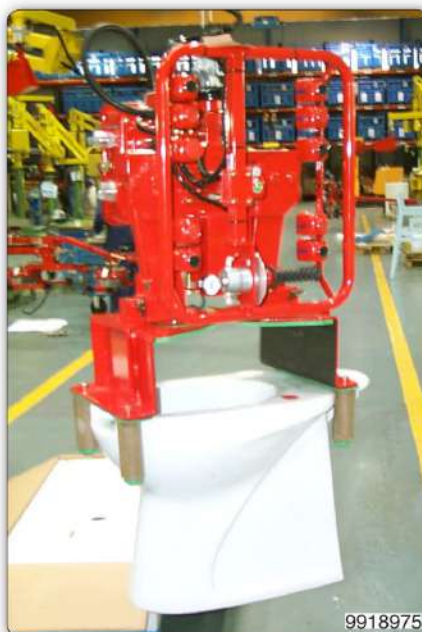
Манипулятор Partner в исполнении на стойке с приспособлением со взаимозаменяемыми присосами, предназначенный для захвата и перемещения раковин разных размеров.
