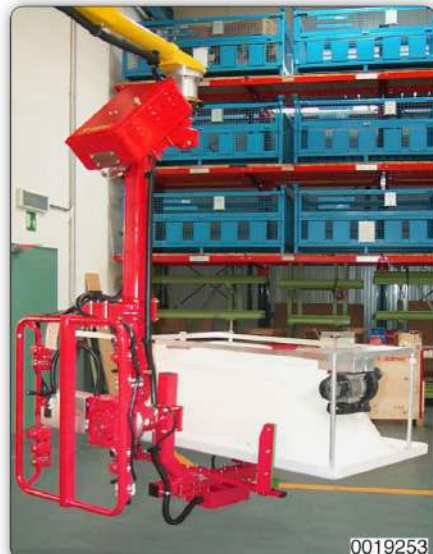
Манипулятор с приспособлением с присосами (Venturi) для захвата и поворота ванн.
