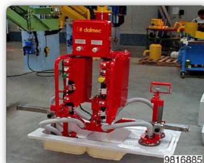
Манипулятор с приспособлением с регулируемыми присосами (Venturi) для перемещения и наклона моек.
