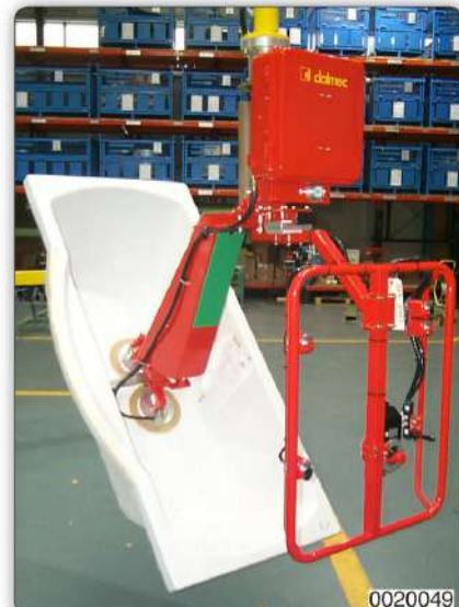
Манипулятор с приспособлением с присосами (Venturi) для захвата и поворота ванн.
