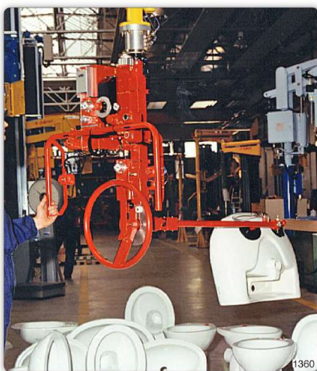
Манипулятор с приспособлением со взаимозаменяемыми присосами для захвата и перемещения сантехнических изделий с устройством ручного поворота.
