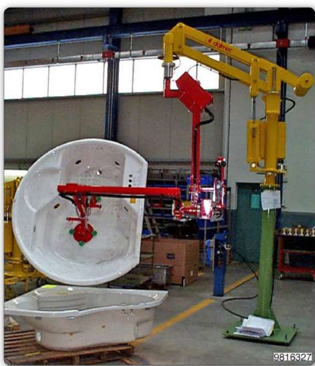
Манипулятор с приспособлением с присосами (Venturi) для захвата и порота ванн.
