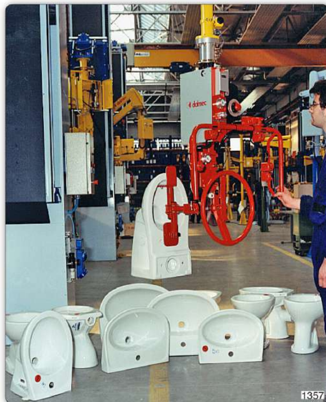
Манипулятор с присосом для захвата и ручного вращения сантехники.
