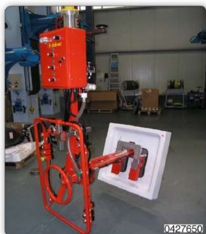
Манипулятор с пневматическим зажимом для захвата и перемещения душевых поддонов.
