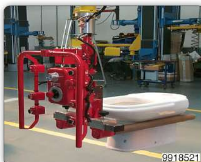
Приспособление с регулируемыми вилами для перемещения унитазов.
