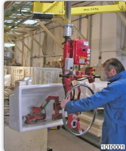
Манипулятор с приспособлением с присосами (Venturi) для захвата и вращения моек.
