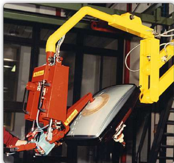
Манипулятор с приспособлением с присосами ("Venturi") для захвата, наклона, поворота электроннолучевых трубок.
