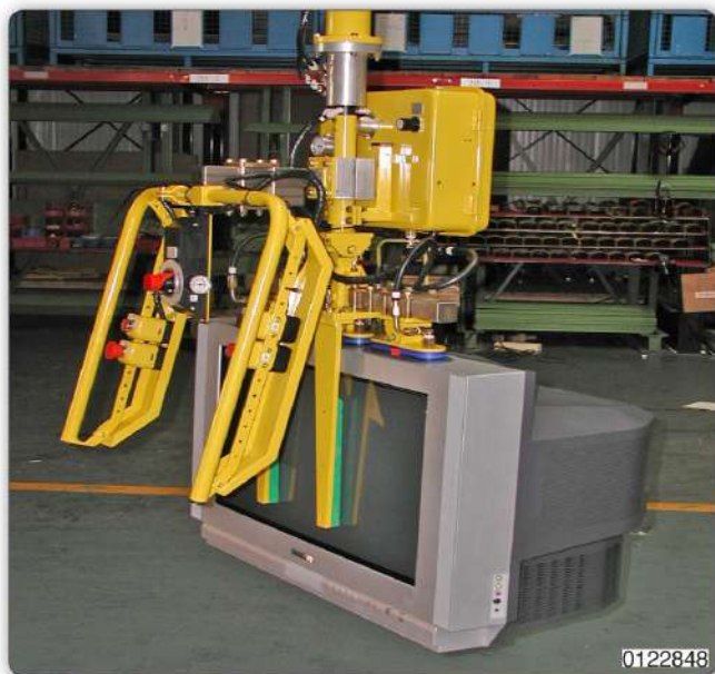
Манипулятор с приспособлением с присосами для захвата телевизоров за экран и их помещения в упаковку.
