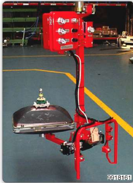
Манипулятор с приспособлением с присосами ("Venturi") для захвата и переворота на 180° при помощи пневмопривода кинескопов. Присос вращается вручную.
