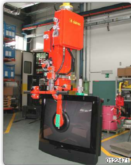
Манипулятор с приспособлением с присосом для захвата и перемещения телевизоров.
