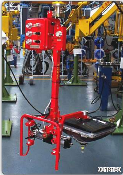
Манипулятор с приспособлением с присосами ("Venturi") для захвата и переворота на 180° при помощи пневмопривода кинескопов. Присос вращается вручную.
