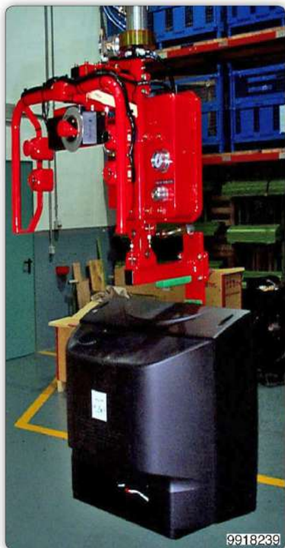
Манипулятор с приспособлением с присосами для перемещения телевизоров с захватом за экран и его помещения в упаковку.
