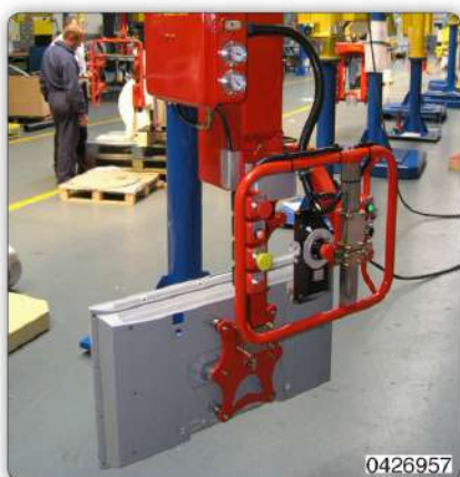
Манипулятор с приспособлением с присосами для захвата и перемещения телевизоров с ж/к экранами.
