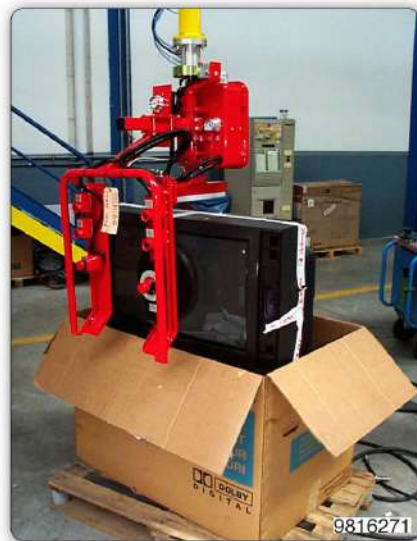
Манипулятор с приспособлением с присосами для захвата телевизоров за экран и их помещения в упаковку.
