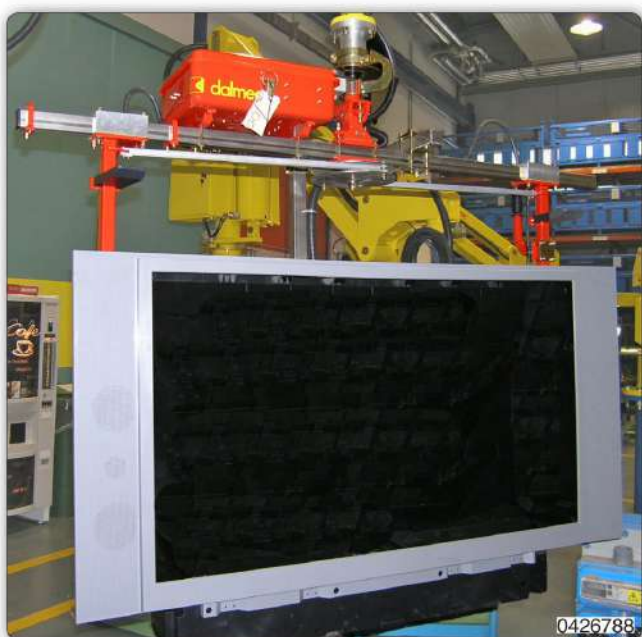
Манипулятор с приспособлением с присосами для захвата и перемещения телевизоров с ж/к экранами.
