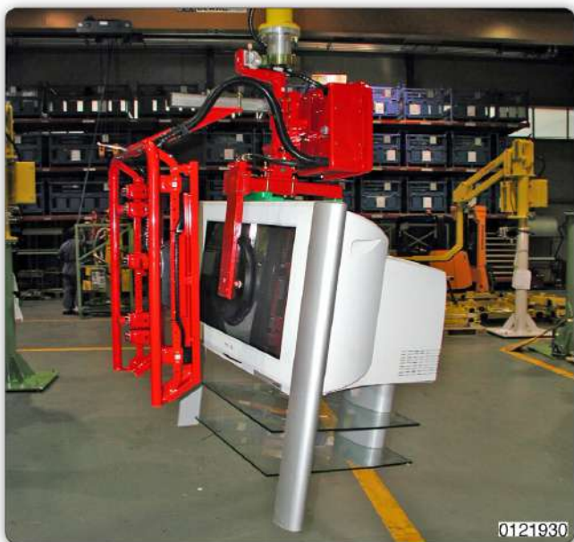
Манипулятор с приспособлением с присосом для захвата и перемещения телевизоров.
