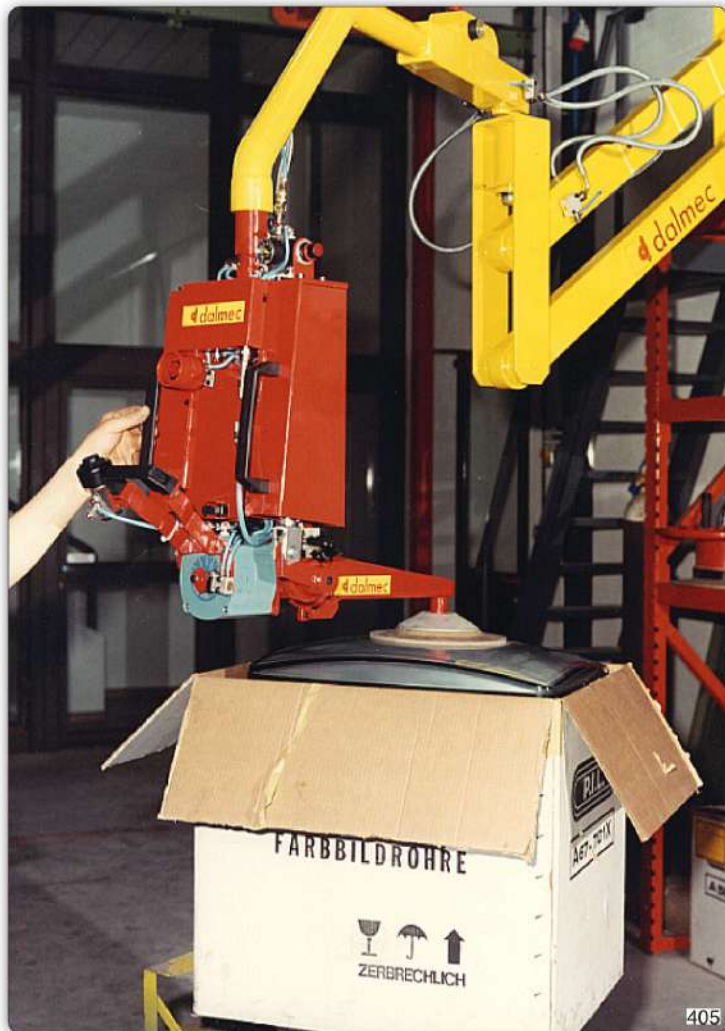
Манипулятор с приспособлением с присосами ("Venturi") для захвата, наклона, поворота электроннолучевых трубок.
