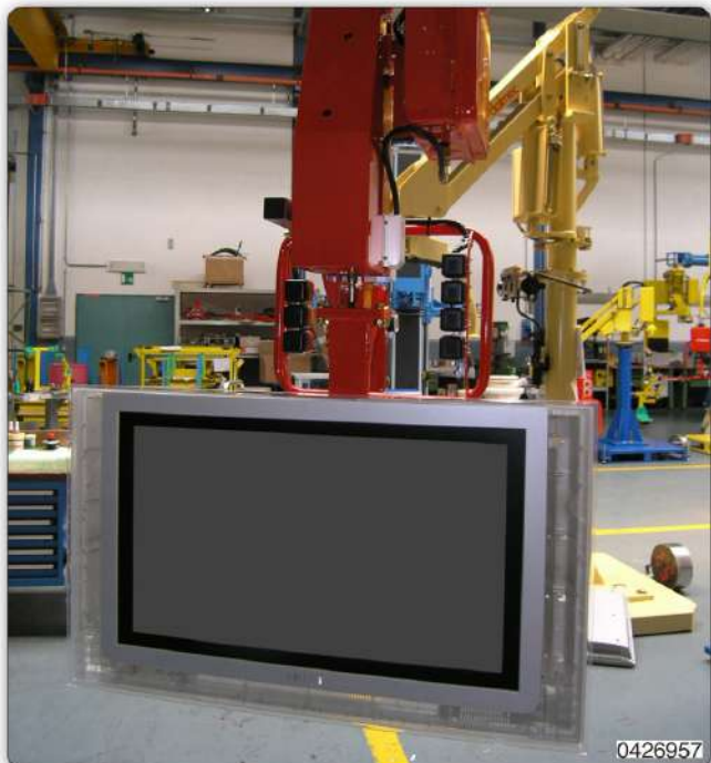
Манипулятор с приспособлением с присосами для захвата и перемещения телевизоров с ж/к экранами.
