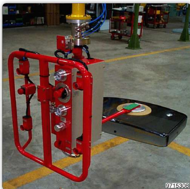
Манипулятор с приспособлением с присосом для захвата, наклона на 90° и перемещения стекол кинескопов.
