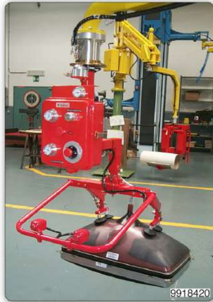
Манипулятор с приспособлением с присосами ("Venturi") для перемещения кинескопов с захватом за конус.
