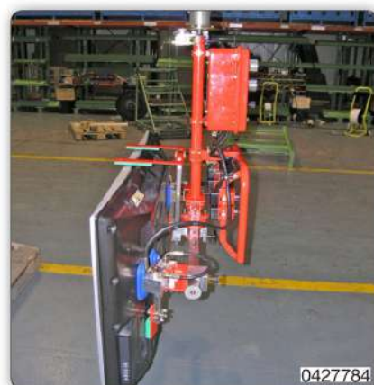
Манипулятор с приспособлением с присосами для захвата и перемещения телевизоров с ж/к экранами.
