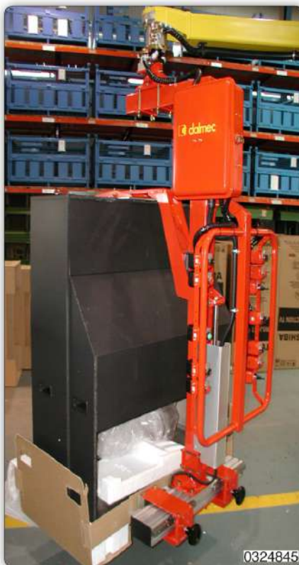
Манипулятор с вильчатым приспособлением для перемещения упакованных телевизоров.
