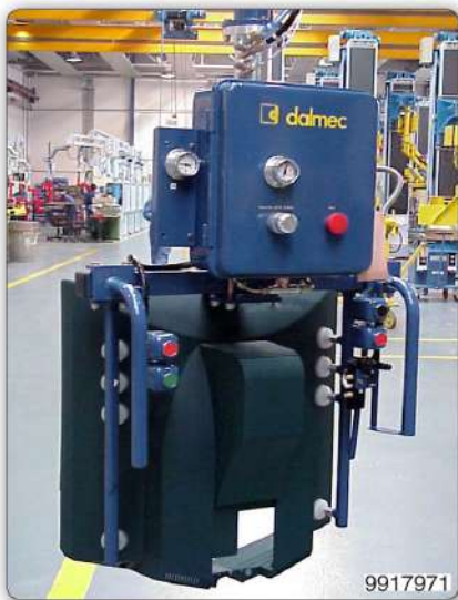
Манипулятор с приспособлением с присосами для захвата и перемещения телевизоров.
